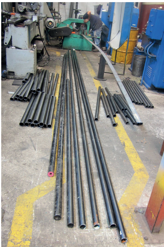
Figura N° 2. Preparación de tubos simuladores en taller metal mecánico
