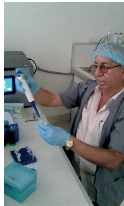
Gráfico 8. Proceso de extracción del ADN de la microbiota aplicando la técnica de PCR, con el Kit Power Soil DNA.
