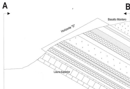
**Figura 4.** Perfil litológico del horizonte "D", mirando al Oeste, obsérvese el horizonte "D", al piso las calizas de Laura superior y al techo el Basalto Montero.
