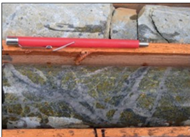
Figura N°4. Testigo o Core de perforación diamantina, en que se muestran las alteraciones propias de un pórfido con estructuras de sílice de sobreimpresión teñidas de jarosita de tonos pardos a amarillos.
