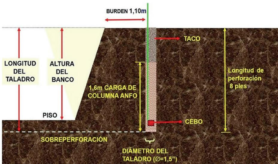
Figura N° 4. Sección de corte - variables determinadas.
