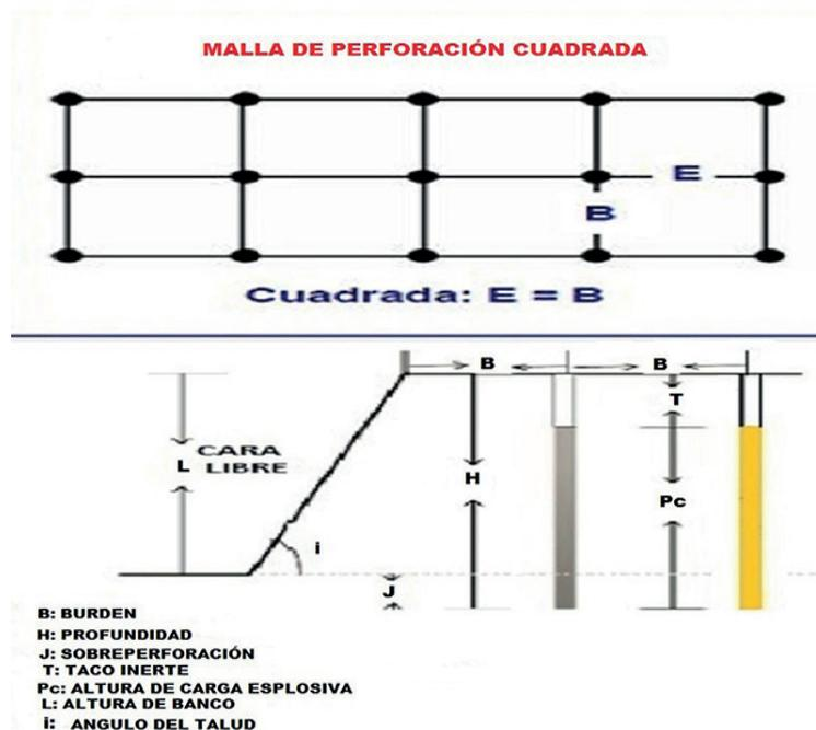
Figura N° 1. Diseño de Voladura en OPEN PIT
