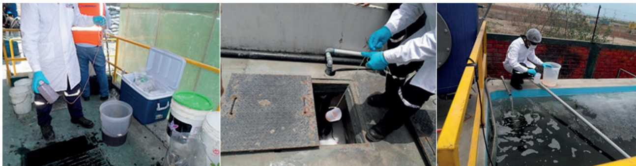
Figura 6. Toma de muestra de agua E-2 Agua residual no tratada (izquierda), E-5 Agua residual tratada-Salida de filtros de grava y arena (centro), E-9 Agua residual tratada-Salida del equipo de osmosis inversa (derecha)
