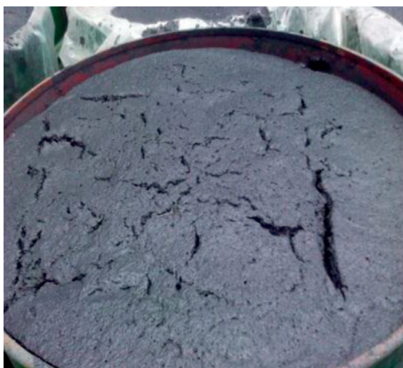
Figura 2. Lodo proveniente del tratamiento sale del filtro prensa de marco y placas.
