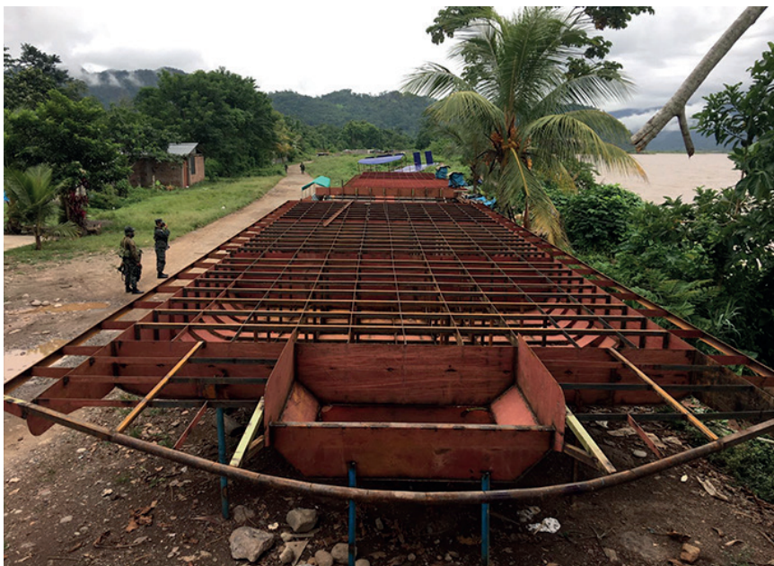
Figura 3. Diseño de construcción convencional tipo chimpa
