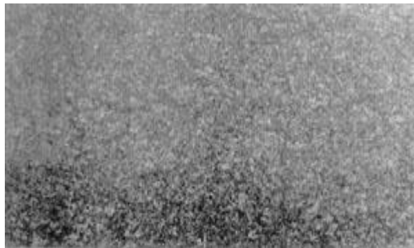
Figura N° 5: Probeta Templada a 850 °C - 1h/agua HRc 64
