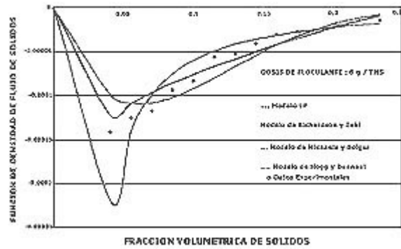
Figura 3.8: Función de Densidad de Sólidos vs. Fracción Volumétrica de Sólidos. F = 9\text{g/TMS}
