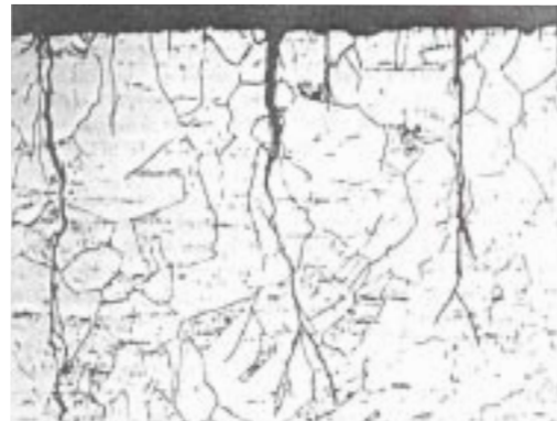
Figura N.º 6. Corrosión por esfuerzo. Transcristalino: AISI 304. Ensayo: 42% MgCl 2 en ebullición. Ataque: Electrolytic, 10% de solución de ácido oxálico, X 100.
