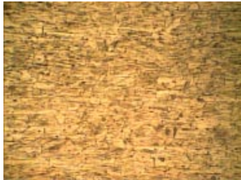
Figura N.º 4. Se observa puntos claros de martensita. Ataque: Electrolytic, 10% de solución de ácido oxálico, 250X.
