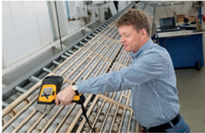
Figura 9. Uso de XRF manual en lecturas de Core (Pérez Barnuevo, 2014)
