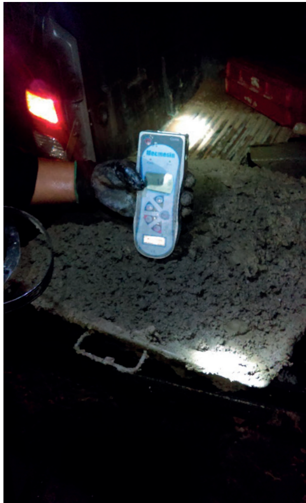
Figura 6. Medición de velocidad de fraguado del concreto con relave.
