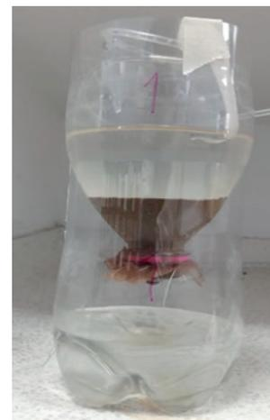
Figura 7. Montaje de embudo, filtro y Relave
