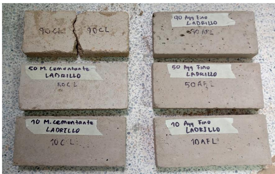
Figura 1. Bloques de ladrillos obtenido a partir de mezclas de arena fina, arena gruesa, cemento y relave minero (diversas proporciones).
