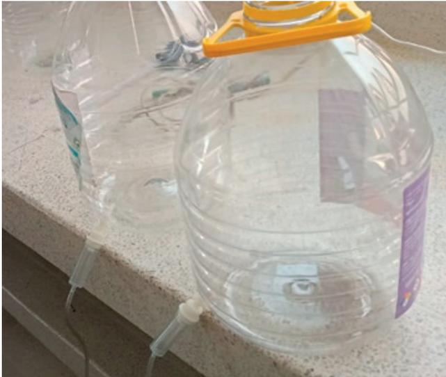
Figura 3. Conexión de las cánulas a los botellones
