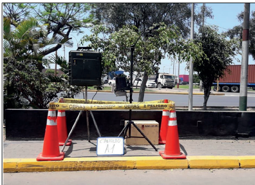
Figura 3. Equipo de monitoreo de benceno en el Establecimiento. Fuente: Informe de monitoreo ambiental de un Establecimiento
