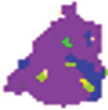
Figura 7. Imagen Qemscan para la muestra 200845005. Mineral de cobre (amarillo) encapsulado en Plagioclasa (lila) y clorita (verde)
