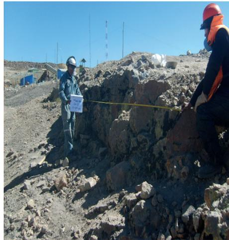
Figura 13. Extracción de muestra de roca.
