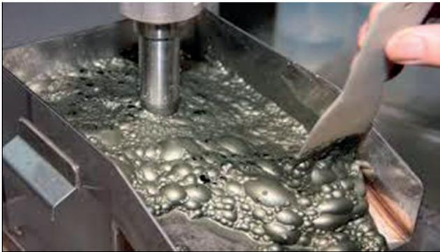
Figura 6. Flotación de sulfuros (calcopirita)
