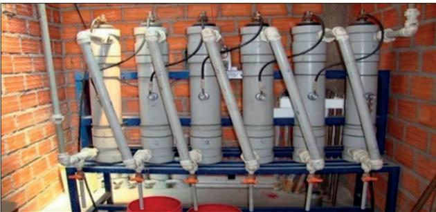
Figura 7. Pruebas en columnas de lixiviación ácida.
