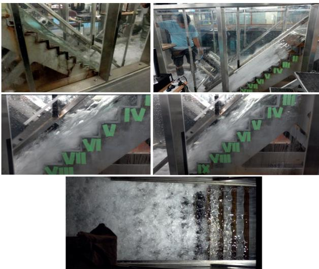
**Figura 19.** Resultados del experimento en aliviadero escalonado a escala para la calibración del modelamiento.
