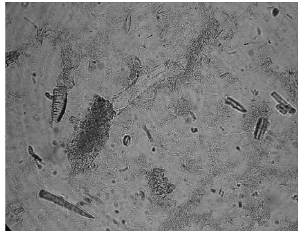
Foto 6. Microscopio petrográfico mostrando espículas de esponja, diatomea y vidrio volcánico, materia orgánica dentro de la arenisca tobacea (los puntos oscuros).
