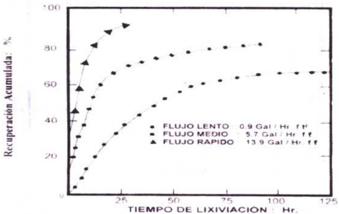
Fig. N° 7. Recuperación de oro vs. Tiempo de lixiviación a diferentes velocidad de flujo
