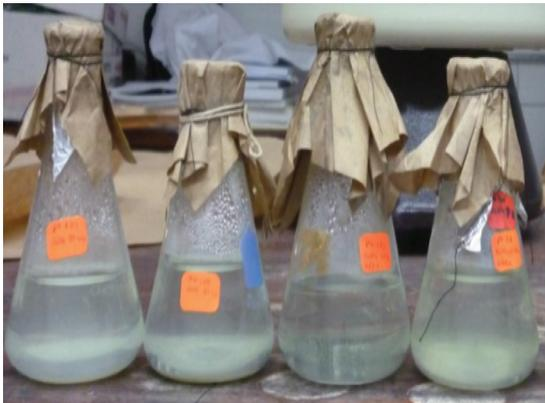
Figura N.º 6. Solución de medio líquido 9k modificado.
