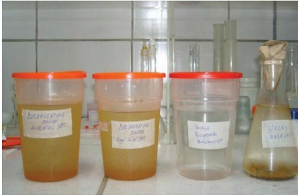
Figura N.º 5. Muestreo de aguas ácidas Nv. 420 y 580, U. Julcani.
