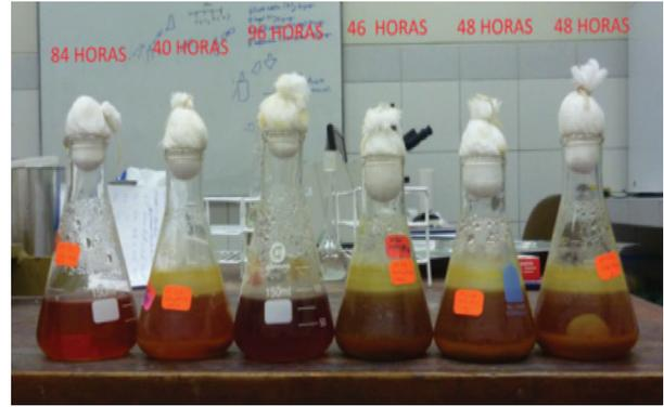
Figura N.º 8. Solución final después de 96 horas de inoculación (luego de la 8.ª resiembra) de matiz rojo óxido intenso por la formación del férrico y la colmatación bacteriana del medio.
