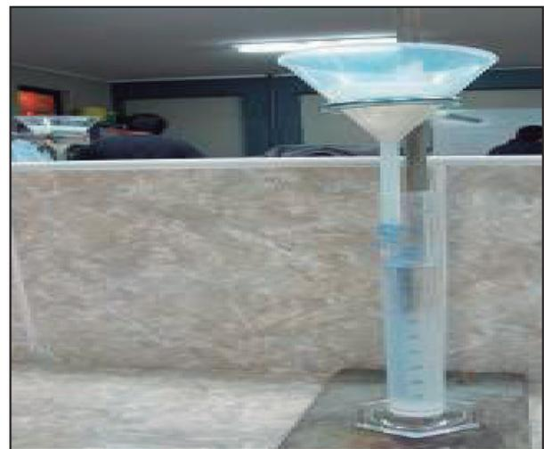
Figura N.º 8. Módulo de pruebas de filtración en laboratorio.
