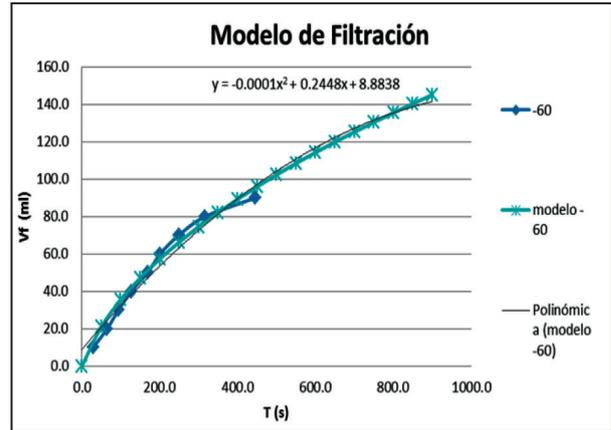
Figura N.º 7. Modelo cinético teórico de filtración.
