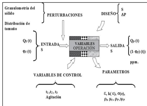
Figura N.º 4. Variables de operación de filtración (Concha, 2008).
