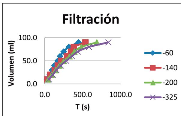
Figura N.º 9. Curvas del modelo de filtración.
