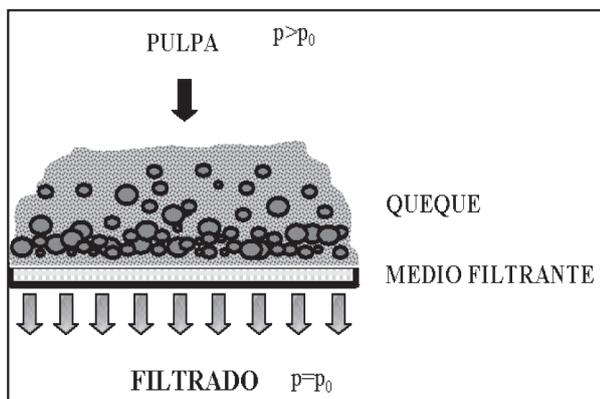
Figura N.º 1. Esquema de filtración (Concha, 2008)
