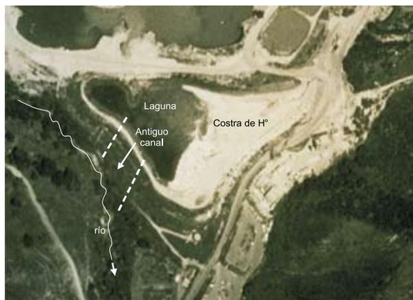
**Figura 5.** Vista aérea de la presa de Tapo Canyon previa a su rotura (Foto de Northridge Collection, Earthquake Engineering Research Center, University of California, Berkeley). La H representa la costra de hormigón.
