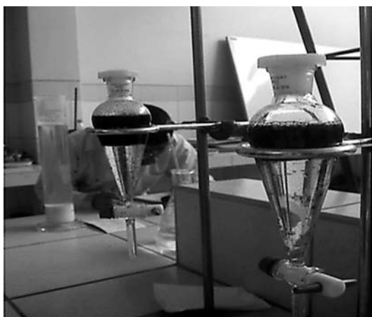
Figura 9. Pruebas Experimentales de SX y Cementación de cobre.
