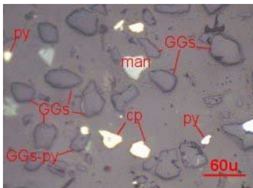
Figura 1. Partículas libres de pirita (py), de manganita (man), de calcopirita (cp) y de gangas (GGs). Nícoles paralelos - 200x.
