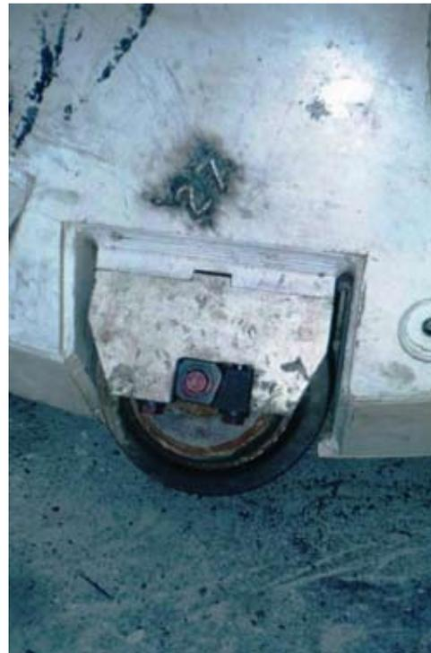
Fotografía N.º 15. Cortador Gauge N.º 27 en el cabezal de la TBM MK 12.
