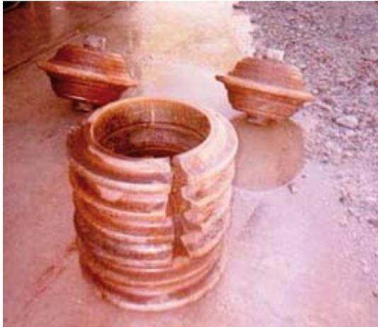
Fotografía N° 18. Disc ring reemplazados cortando con oxicorte.
