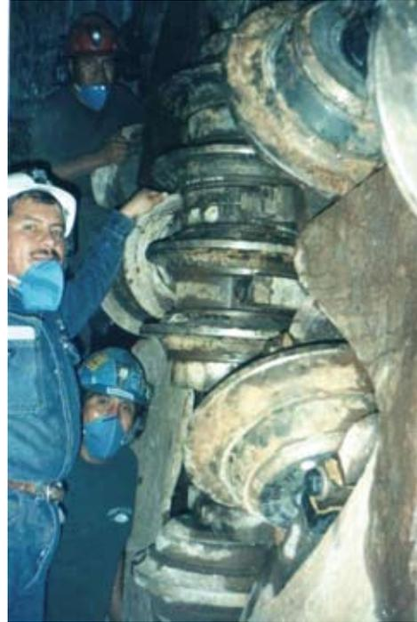
Fotografía N.º 14. Face cutters montados en el cabezal de la TBM.
