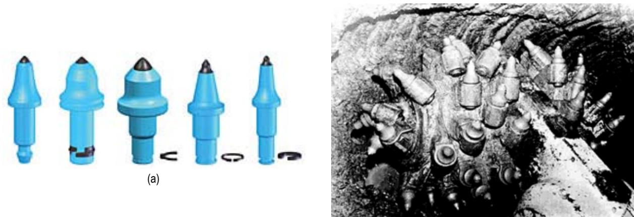
Fotografía N.º 6. Cortadores de picas. a) Picas G-38 (Sandvik). b) Picas en el cabecal de un roadheader.
