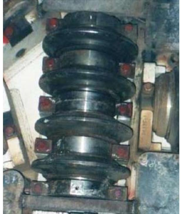
**Fotografía N.º 2.** Cortadores centrales en el cabezal de la TBM.
