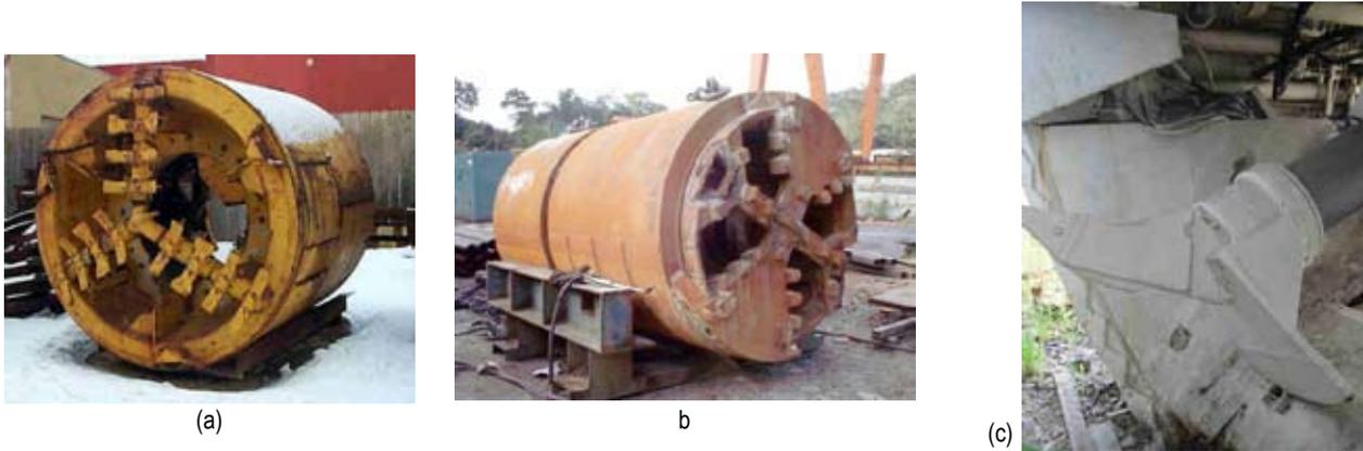
Fotografía N.º 4. Cabecal de TBM. a) Con cortadores de picas (picks). b) Con cortadores de picas de arrastre (drag picks). c) Cortador de azadón (hoe) en TBM.
