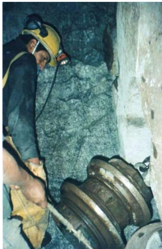
Fotografía N.º 13. Extracción de cortadores centrales desgastados para su cambio.
