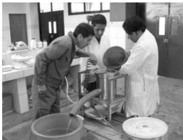
Figura N.º 7. Alimentación del relave de amalgamación al concentrador Falcon.
