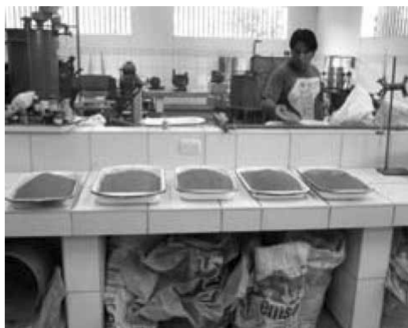
Figura N.º 6. Relaves de amalgamación para las pruebas.
