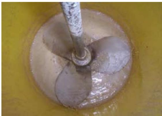
Foto N.º 1. Sistema de cianuración dinámica de relave: eje-paleta-solución a cianurar.
