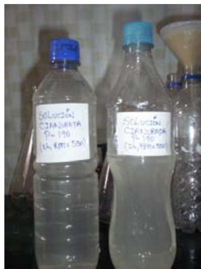
Foto N.º 4. Soluciones filtradas provenientes de cianuración de relave de Ticapampa.
