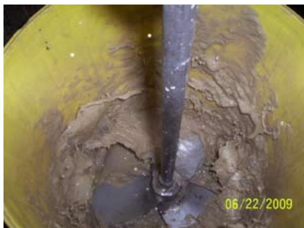
Foto N.º 3. Mecanismo de agitación intensa de la cianuración dinámica, empleando velocidad de agitación de 550 rpm.
