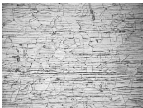
Microfotografía N° 1. Acero Inoxidable. AISI 304. Microestructura: Austenítica. Ataque: Electrolítico, 10% de solución de ácido oxálico.
