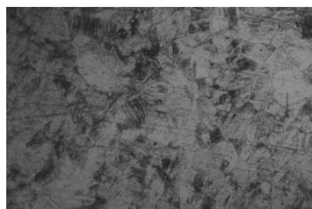
Microfotografía N° 4. Tratamiento térmico de la probeta N° 2 a 800°C, se observa la recuperación de los granos y la fase austenítica. Ataque: Electrolítico, 10% de solución de ácido oxálico, 200X.
