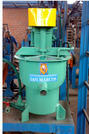
Foto N.º 4. Celda "San Marcos" instalada en los circuitos de la Planta Piloto de flotación.
