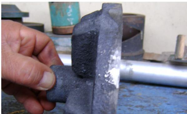
Foto N.º 2. Fundición del impulsor.
