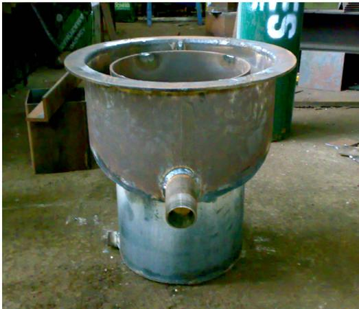
Foto N.º 1. Tanque de agitación y canales de salida de productos.
