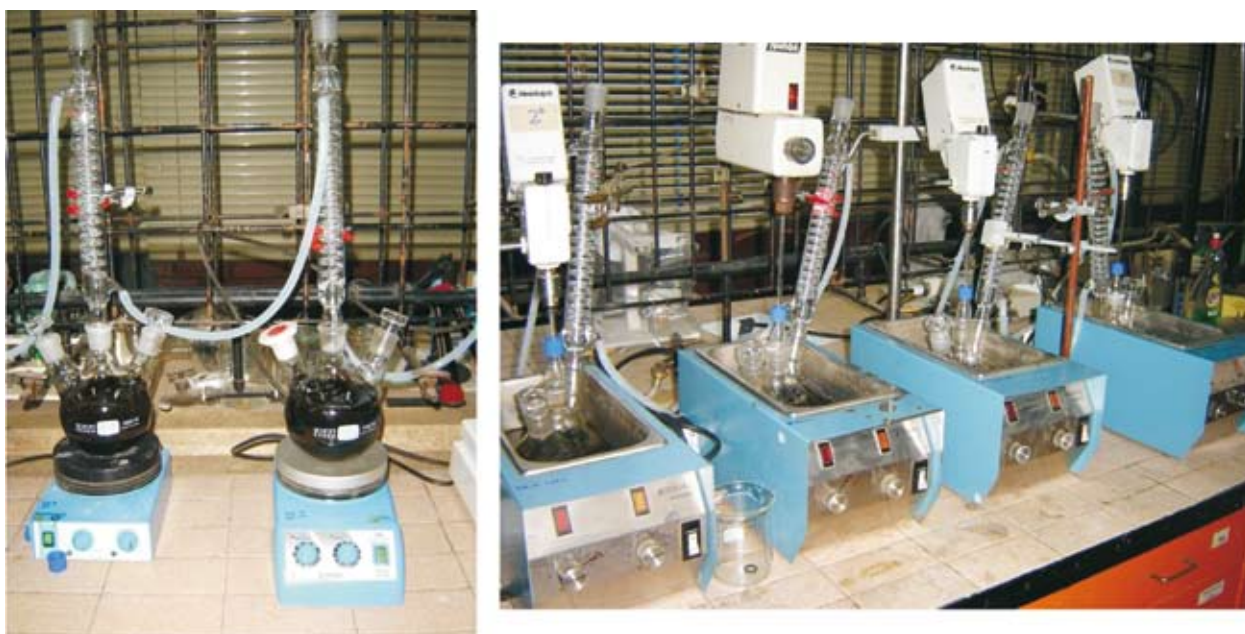
Figura N.º 5. Reactores usados en ensayos de estabilidad química.
