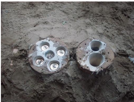
Figura 2. Barras coladas en moldes de arena.
