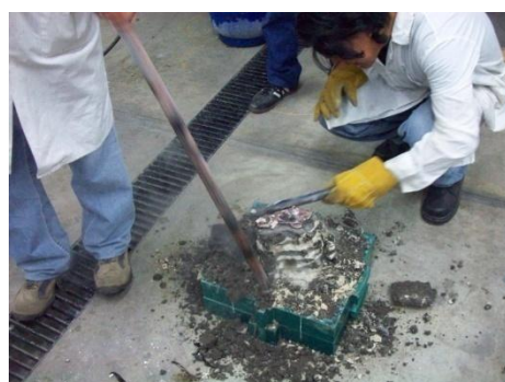
Figura 4. Desmoldeando las barras solidificadas en los molde.
