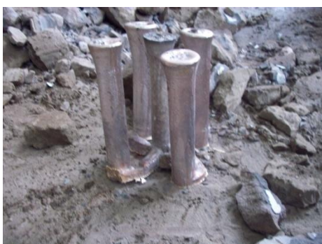
Figura 3. Barras fundidas para examinar.
