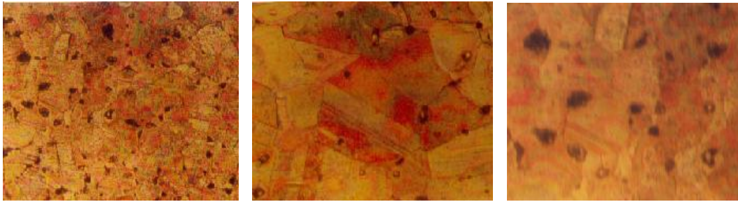
Microfotografía 1. Bruto de colada A 200X y 400X, respectivamente Ataque con Cloruro Férrico
