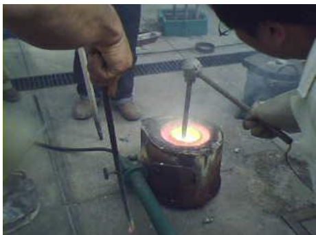
Figura 1. Fundición, controlando la temperatura
