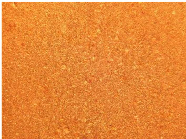
**Figura 5.** Morfología superficial del cátodo de cobre obtenido sin usar aditivos surfactantes.
