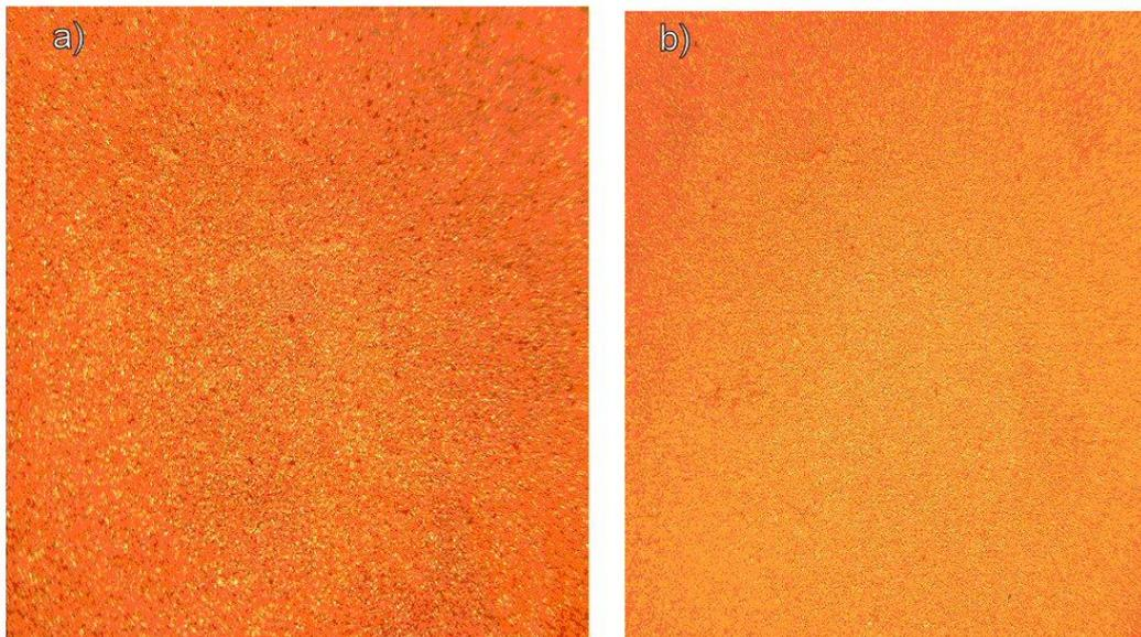
**Figura 7.** Morfología superficial del cátodo de cobre obtenido al utilizar Flotanol C-7 en dosis de a) 15 mg/L y b) 20 mg/L.
