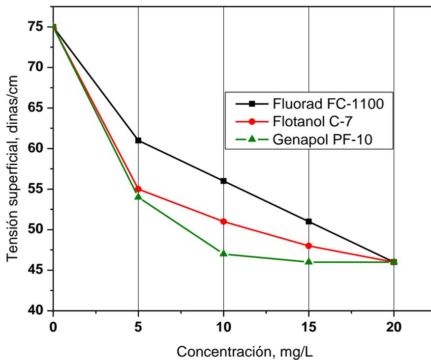
**Figura 2.** Efecto de la concentración y tipo de surfactante en la tensión superficial.
