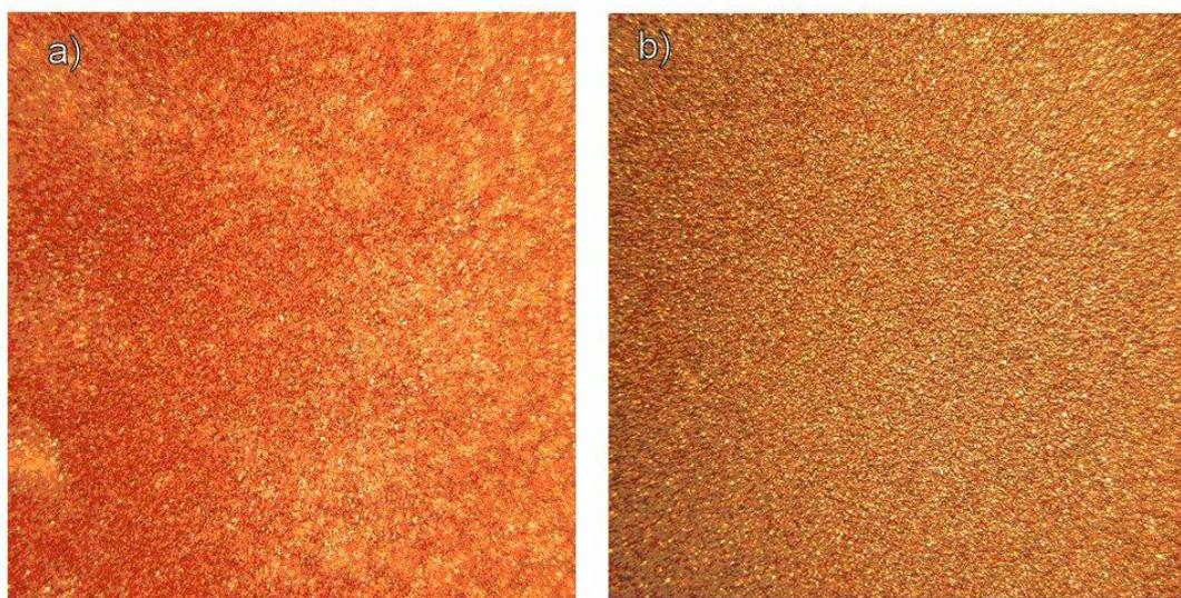
**Figura 6.** Morfología superficial del cátodo de cobre obtenido al utilizar Fluorad FC-1100 en dosis de a) 15 mg/L y b) 20 mg/L.
