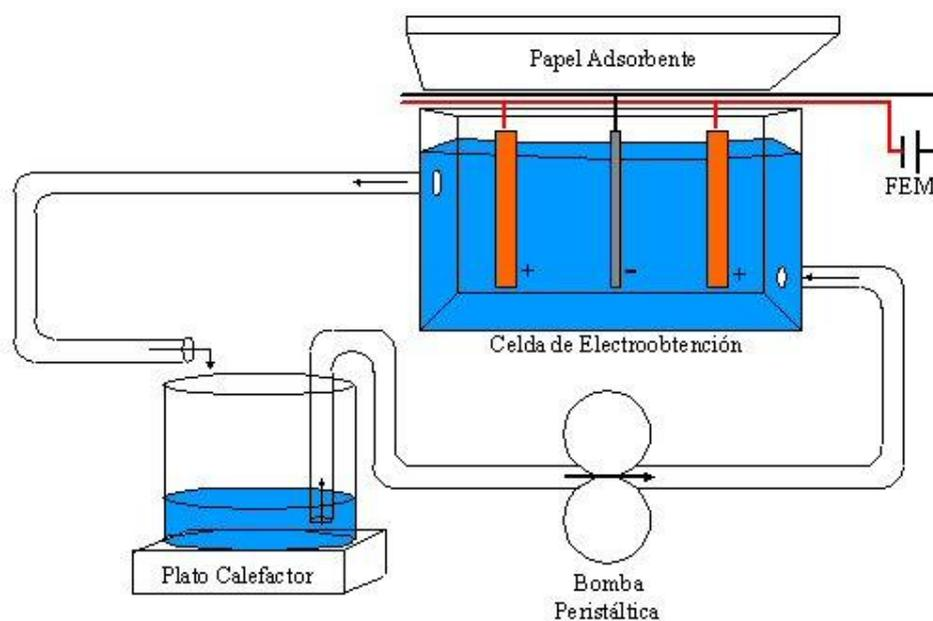
**Figura 1.** Montaje experimental pruebas de electroobtención de cobre.
