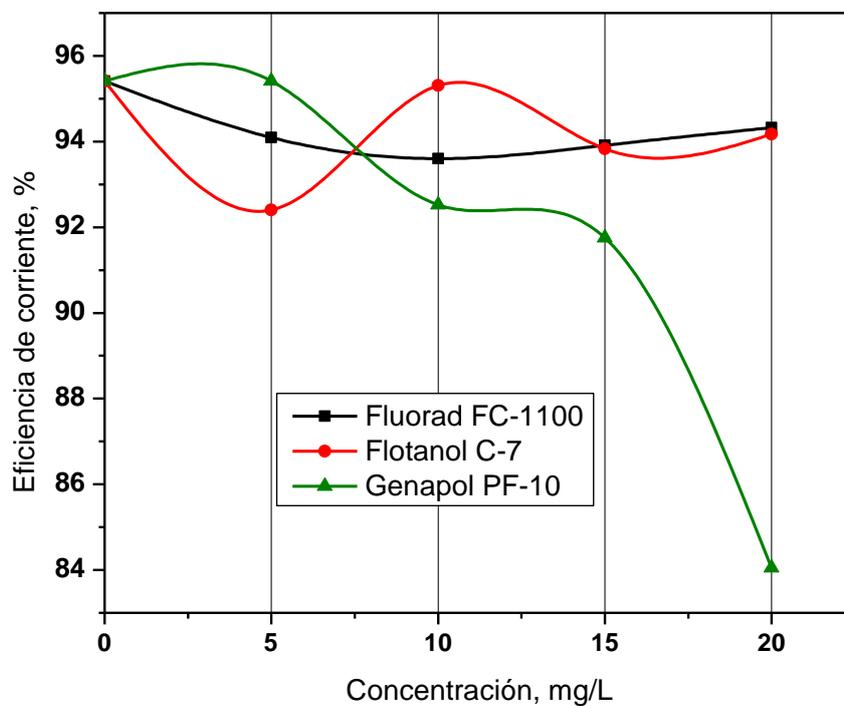
**Figura 4.** Efecto del tipo y concentración de aditivos sobre la Eficiencia de Corriente.
