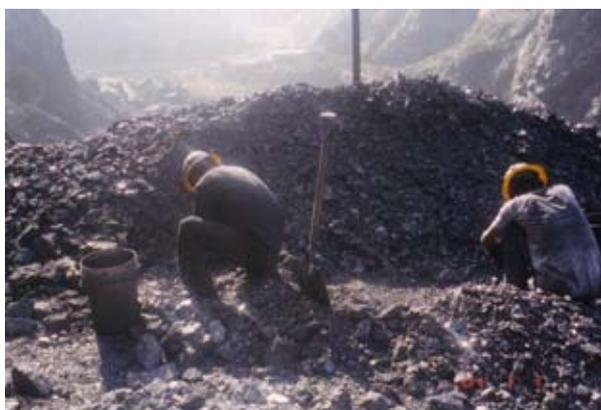
**Foto 6.** Selección manual del carbón de la pizarra (pallaqueo) en la mina Chimú 1, Cascas-La Libertad.
