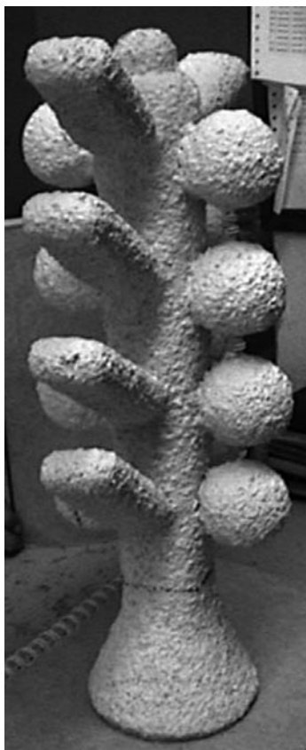
Foto 1. Montaje de probetas para ensayos de flexión MOR (rectangulares) y de permeabilidad (esféricas).
