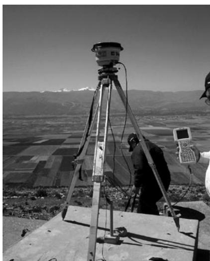
Foto 3. GPS geodésico instalado en C° Gauss.
