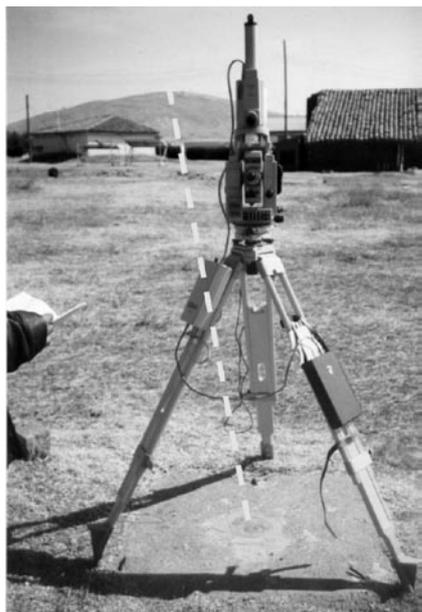
Foto 2. Giróscopo instalado en la Estacion Huancayo.
