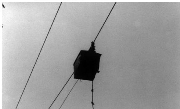
**Foto 2.** Cable carril para cruzar de un bando a otro de la quebrada con carbón extraído de las minas.
