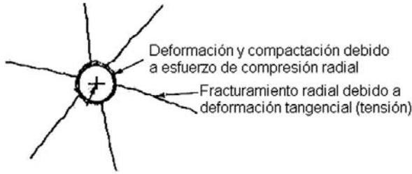
Figura N° 7. Acción inicial de la detonación del explosivo en el taladro.
