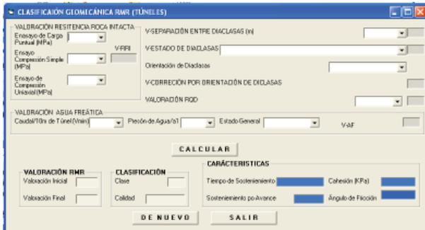
Fig. 2. Interfaz de cálculo de sostenimiento en túnel.
