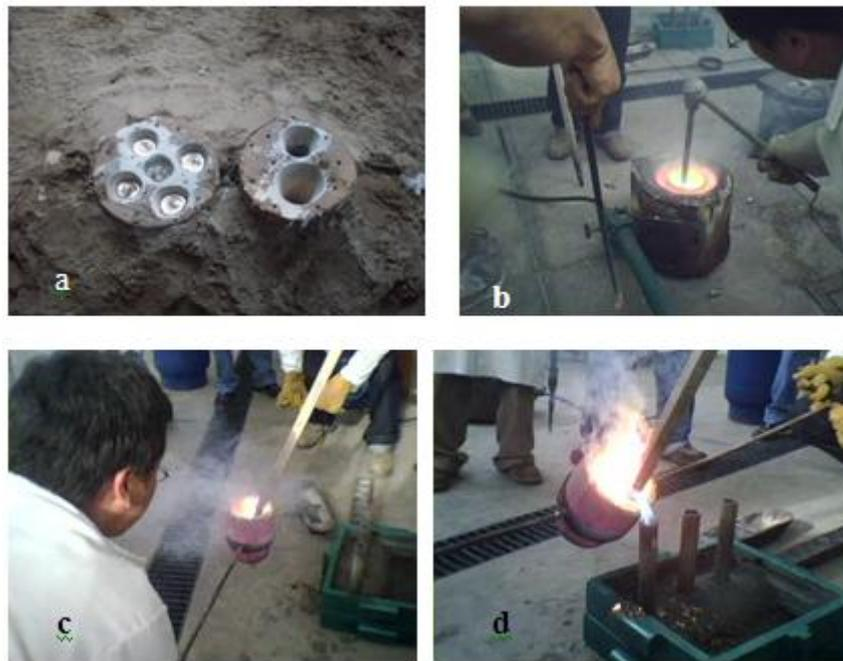
Figura 3. a) Barras en molde de arena. b) Fusión en horno de crisol, verificando la temperatura del metal. c) Preparando el vertido en moldes metálicos. d) Vertido en moldes metálicos. Laboratorio – Taller de la Escuela de Ingeniería Metalúrgica. UNM. San Marcos
