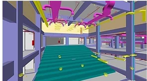
Figura 7. El BIM es una representación virtual y tridimensional de los componentes de la edificación, al nivel de detalle que se requiera. (Teatro del nuevo edificio de la Universidad del Pacífico - GyM)
