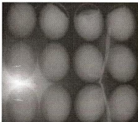
Fig. 6. Placa radiográfica de bolas de 3" (primera prueba), defectos en la parte superior.
