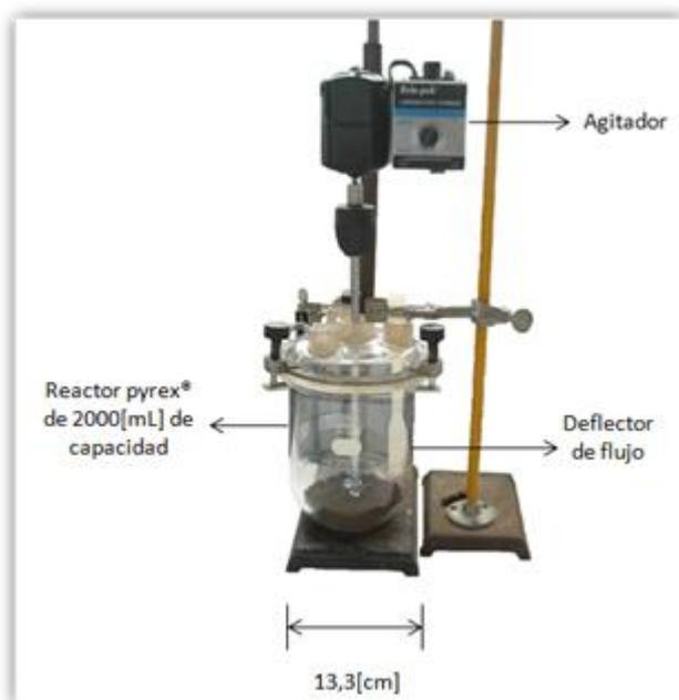
**Figura 1. Montaje experimental empleado en la investigación para realizar los ensayos de lixiviación dinámica.**
