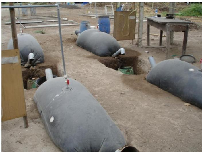
**Foto N°1. Biodigestores tubulares de PVC instalados en CEMTRAR - UNALM**
