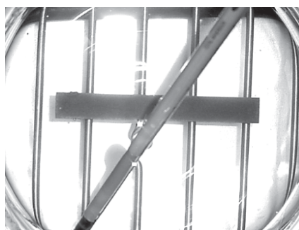
Figura 4. Corpo de prova imerso em solvente.
