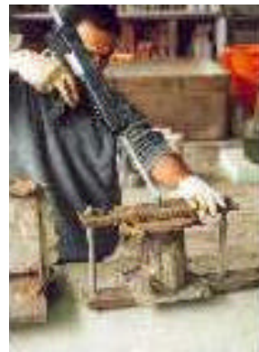
Inyección de resina en grava contenida en molde cilíndrico metálico
