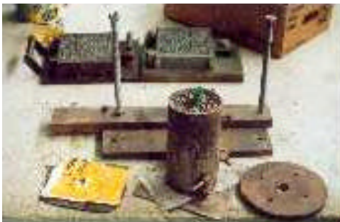
Moldes metálicos llenos de grava
