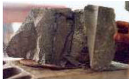
Fallamiento de la lechada de cemento vaciado en taladro de muestra de roca. Prueba de adherencia.
