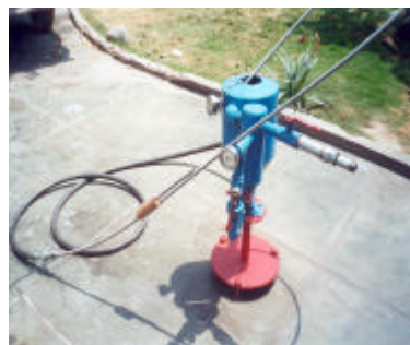
Inyector neumático de grava mostrando manguera, tubo de grava y tapón de madera.
