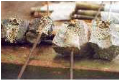
Muestras de roca falladas en la prueba de adherencia con mortero. Riolita (derecha), andesita (izquierda)
