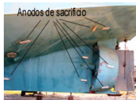
Ánodos de sacrificio (zinc) distribuidos a lo largo del casco
