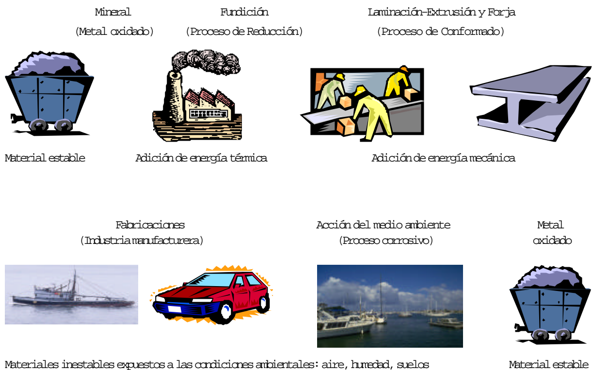
Figura N.º 1. Muestra la espontaneidad del proceso de corrosión
