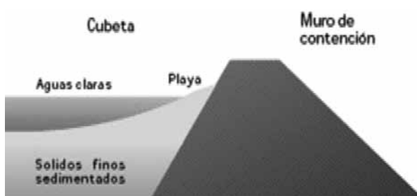
Figura N.º 1. Relavera. Dique y cubeta.
