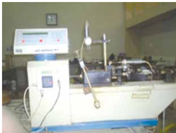
Figura N.º 7. Equipo de pruebas de corte en suelos (Lab. Mec. de suelos Fac. de Ing. Civil UNI).
