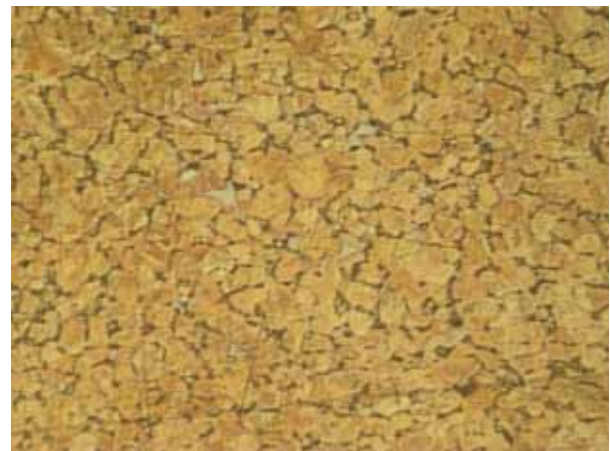
Figura N.º 3. Material II borde trefilado.- tomada a 200x atacada con cloruro férrico, se observa granos de forma dendrítica basta (gruesa) con pequeñas fases dispersas de bismuto.
