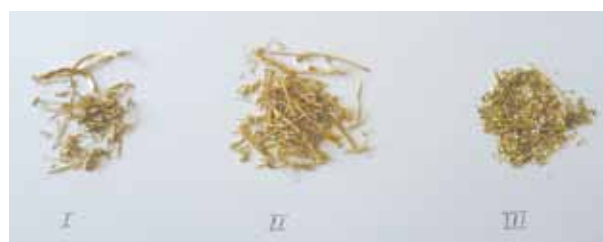
Figura N.º 9. Muestras de viruta de los materiales I, II y III corresponden al tipo 7 de maquinabilidad del estudio de J. Faustmann.
