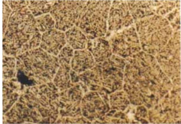
**Figura N.º 5.** Granos limitados por la matriz fase alfa ( $\alpha$ ) el eutectoide alfa +  $\gamma_2$  ( $\alpha+\gamma_2$ ) y los constituyentes k claros ricos en níquel y oscuros ricos en hierro.
